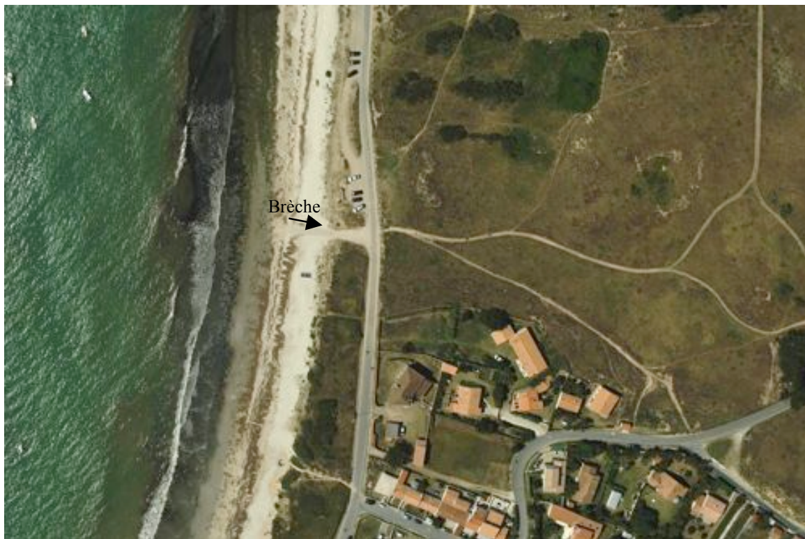
Fig. 12 – La situation avant le passage de la tempête Xynthia : le cordon dunaire est très fragmenté dans sa partie nord, en raison de l'ouverture de passages dans la dune. Le cordon de galets est adossé au bourrelet dunaire qui le sépare de la route côtière goudronnée.
